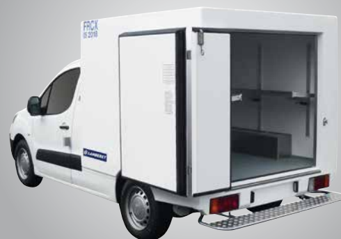
Accès arrière 2 battants (série) / Etagères relevables (option)
