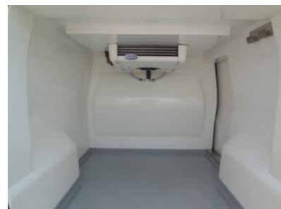
Zone de chargement avec évaporateur
