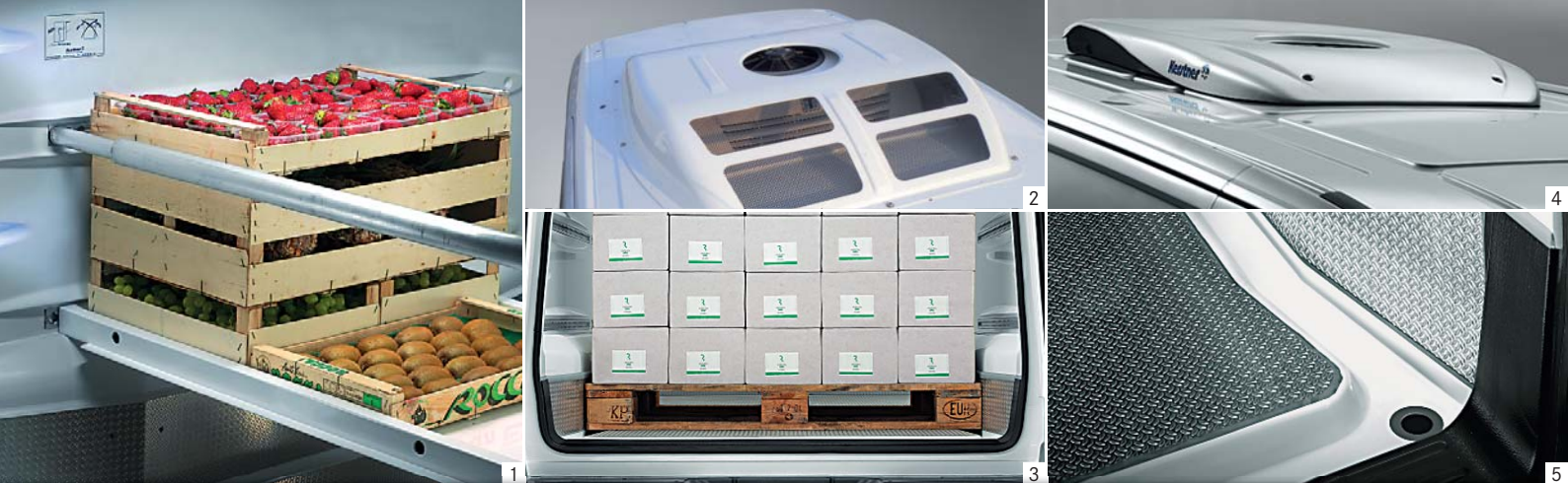
1. Chargement et déchargement rapides grâce à des étagères amovibles faciles à installer et à retirer (options). - 2. Groupe poulie moteur froid négatif, encastré sous cache aérodynamique. - 3. Chargement possible d'europalettes. - 4. Groupe électrique froid positif, sous cache aérodynamique extra-plat, hauteur limitée à 1.98 m. - 5. La gouttière permet d'évacuer facilement les eaux usées de nettoyage.
