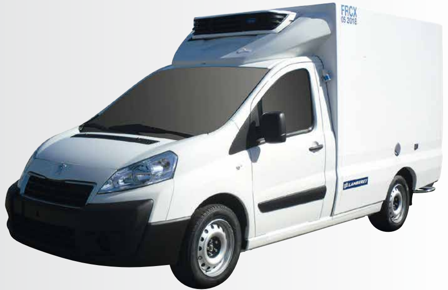
Cellule isotherme moulée profilée aérodynamique
