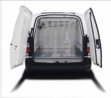
Volume cubique avec protection inox au passage de roue
