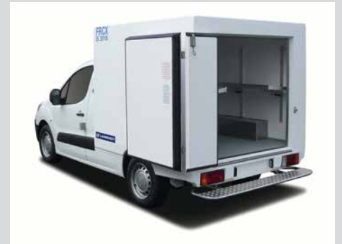
Accès arrière 2 battants ; Passage de roue 1,21 m pour 2 europalettes
