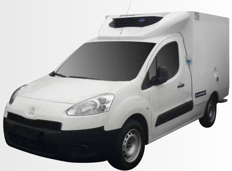
Cellule isotherme moulée profilée aérodynamique
