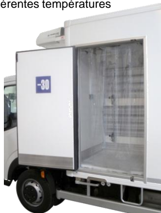
Porte latérale Associée à une ou plusieurs cloisons il est possible de créer des compartiments de différentes températures
