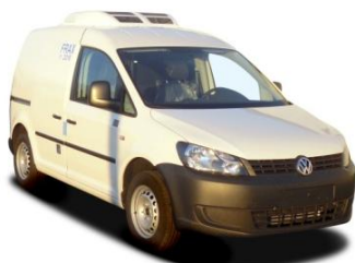
Modèle présenté: avec groupe poulie-moteur THERMOKING
